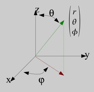
$$\begin{pmatrix} r \\ \theta \\ \phi \end{pmatrix} = \begin{pmatrix} \sqrt{(v_x^2 + v_y^2 + v_z^2)} \\ \cos^{-1}(v_z/r) \\ \tan^{-1}(v_y, v_x) \end{pmatrix}$$
